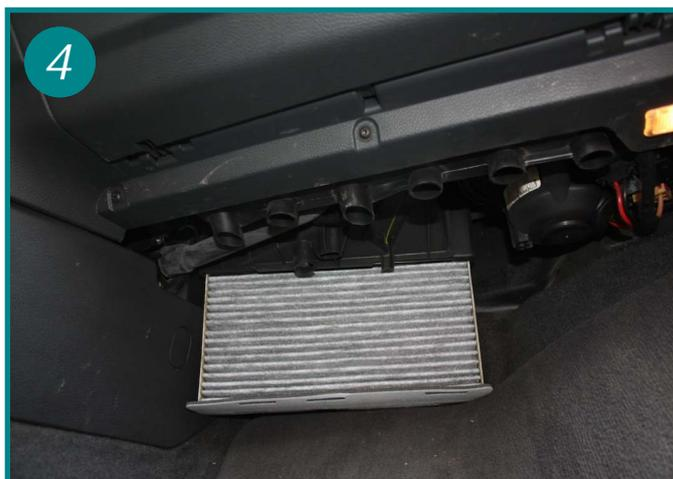
Extraire l'élément filtrant par le bas et le remplacer. Le remontage s'effectue dans l'ordre inverse du démontage.
