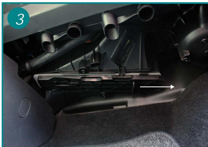
Faire coulisser le couvercle du boîtier filtrant dans le sens de la flèche et le retirer.
