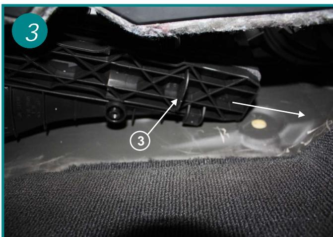
Ouvrir le boîtier filtrant en déplaçant le couvercle vers la droite d'environ 3 à 4 cm (voir flèche) et en s'aidant de la poignée (3).
