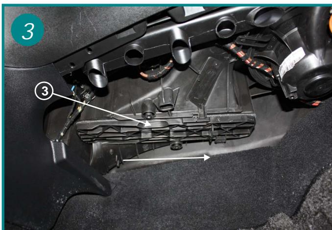
Faire coulisser le couvercle du boîtier filtrant (3) dans le sens de la flèche et le retirer.
