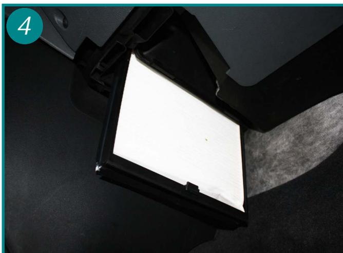
Replacer un nouvel élément dans son cadre en imbriquant les 2 premiers plis à chaque extrémité dans les nervures prévues à cet effet. Le remontage s'effectue dans l'ordre inverse du démontage.
