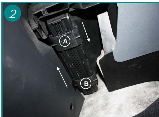
Faire coulisser A et B vers le milieu du couvercle dans le sens des flèches, retirer le couvercle en le faisant pivoter sur le devant.
