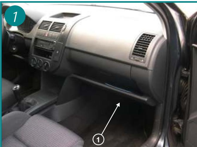
Le filtre d'habitacle est situé à l'intérieur du véhicule, côté passager sous la boîte à gants (voir flèche 1).
