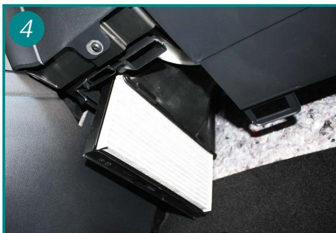
Extraire l'élément filtrant et son cadre, le dissocier du cadre et le remplacer.
