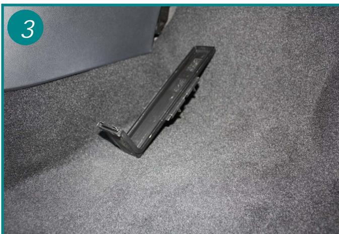
Déposer le couvercle du boîtier filtrant.
