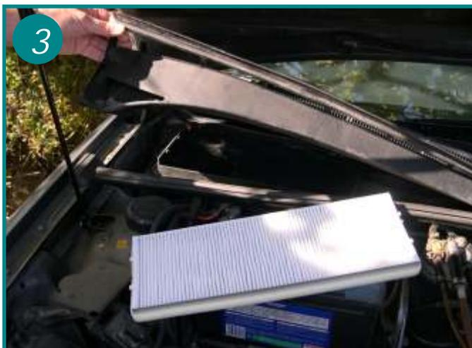
Extraire l'élément filtrant usagé et le remplacer par un nouvel élément.
