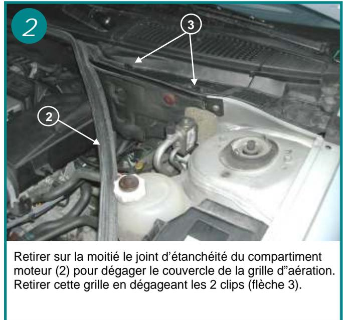
Retirer sur la moitié le joint d'étanchéité du compartiment moteur (2) pour dégager le couvercle de la grille d'aération. Retirer cette grille en dégageant les 2 clips (flèche 3).
