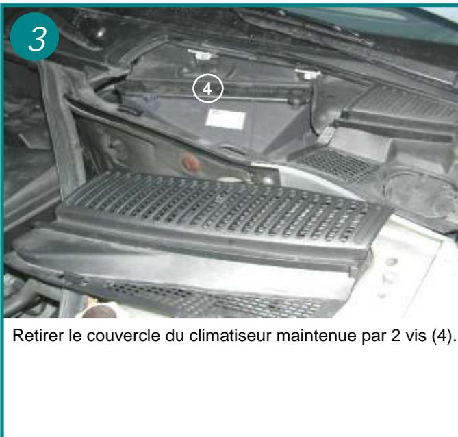
Retirer le couvercle du climatiseur maintenue par 2 vis (4).
