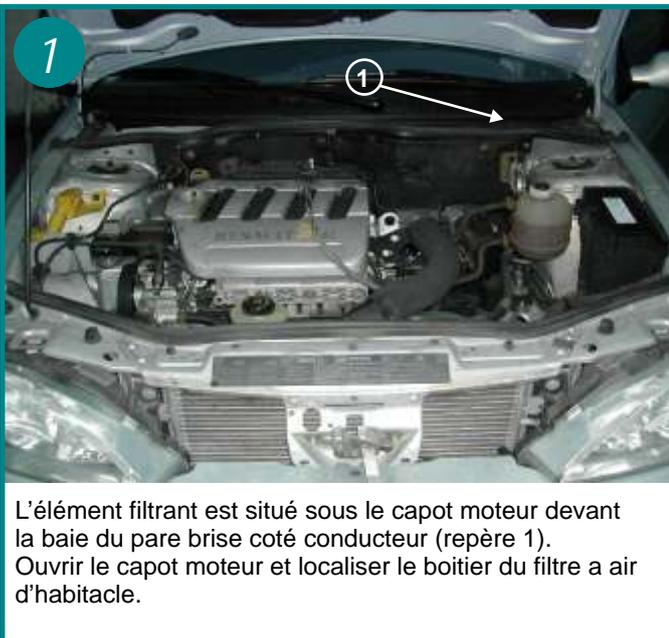
L'élément filtrant est situé sous le capot moteur devant la baie du pare brise coté conducteur (repère 1). Ouvrir le capot moteur et localiser le boîtier du filtre a air d'habitacle.
