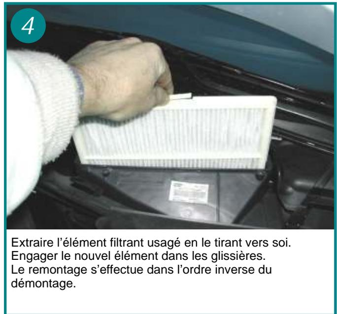
Extraire l'élément filtrant usagé en le tirant vers soi. Engager le nouvel élément dans les glissières. Le remontage s'effectue dans l'ordre inverse du démontage.
