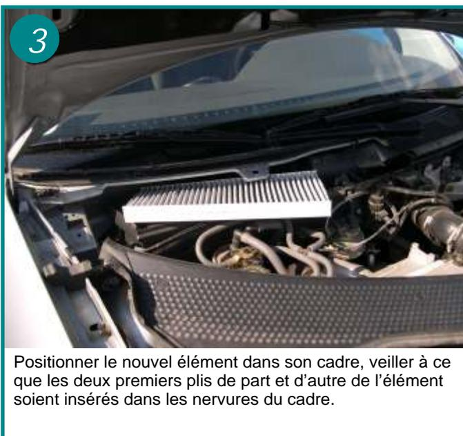
Positionner le nouvel élément dans son cadre, veiller à ce que les deux premiers plis de part et d'autre de l'élément soient insérés dans les nervures du cadre.
