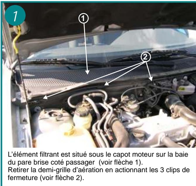
L'élément filtrant est situé sous le capot moteur sur la baie du pare brise coté passager (voir flèche 1). Retirer la demi-grille d'aération en actionnant les 3 clips de fermeture (voir flèche 2).
