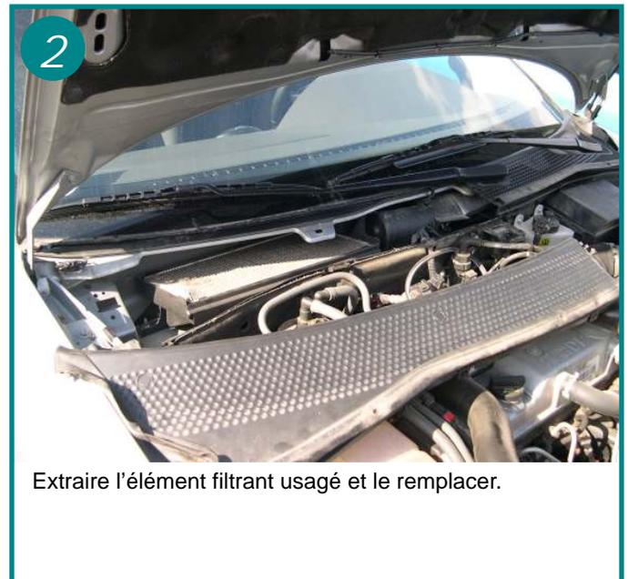
Extraire l'élément filtrant usagé et le remplacer.
