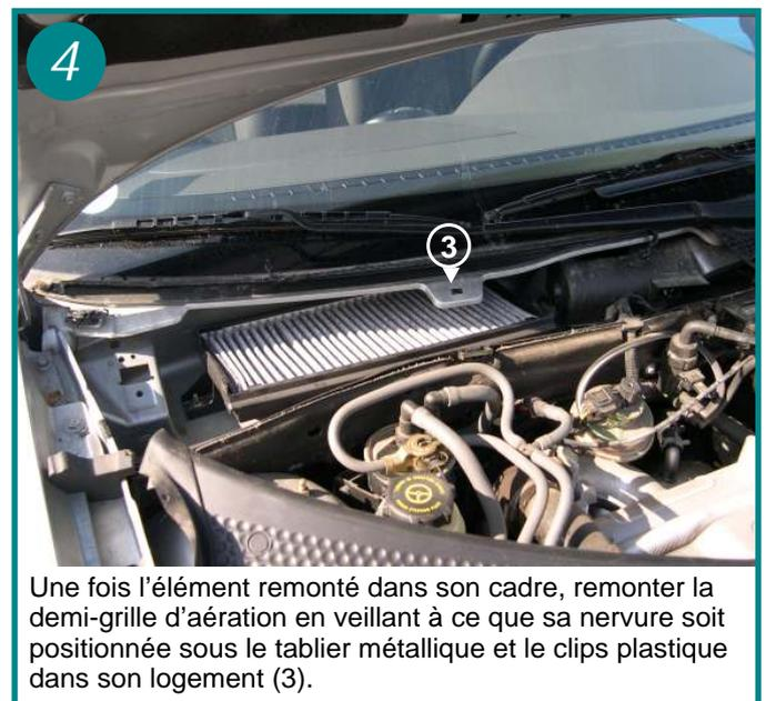
Une fois l'élément remonté dans son cadre, remonter la demi-grille d'aération en veillant à ce que sa nervure soit positionnée sous le tablier métallique et le clips plastique dans son logement (3).
