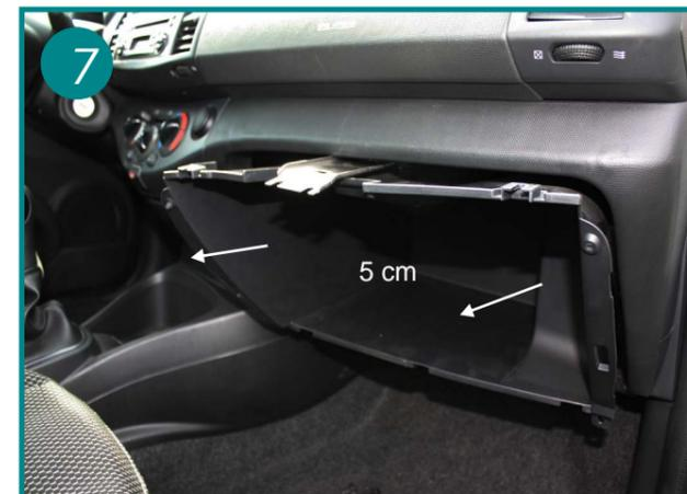
7 Sortir d'environ 5 cm le bloc boîte à gants (voir flèches) il n'est pas nécessaire de l'extraire totalement.
