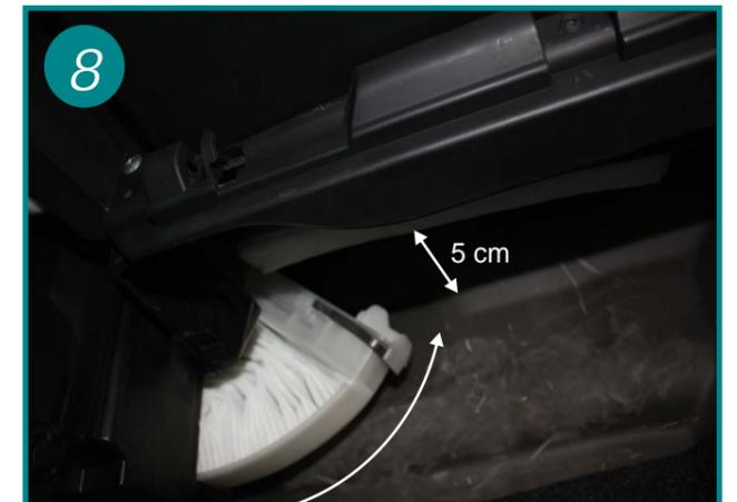
8 Extraire le filtre usagé en le déformant, le faire passer derrière le bloc boîte à gants écarté. Procéder à son remplacement. Le remontage s'effectue dans l'ordre inverse du démontage.
