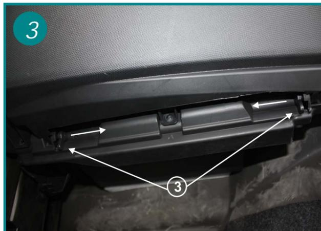
3 Retirer les 2 loquets de maintien de la porte de boîte dans le sens des flèches (3).
