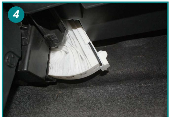
Remettre un élément filtrant neuf en procédant de la même manière en engageant le haut du filtre en premier. Une fois remplacé, à l'aide de la poignée presser fortement jusqu'au « clic » de verrouillage.
