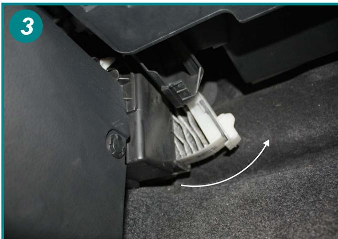
Extraire l'élément filtrant usagé en le déformant en faisant un arc de cercle (voir flèche).
