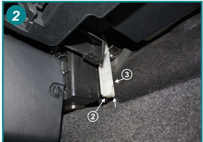
Appuyer sur la patte plastique (2) dans le sens de la flèche en maintenant la poignée (3) puis tirer fortement pour dégager l'élément filtrant.
