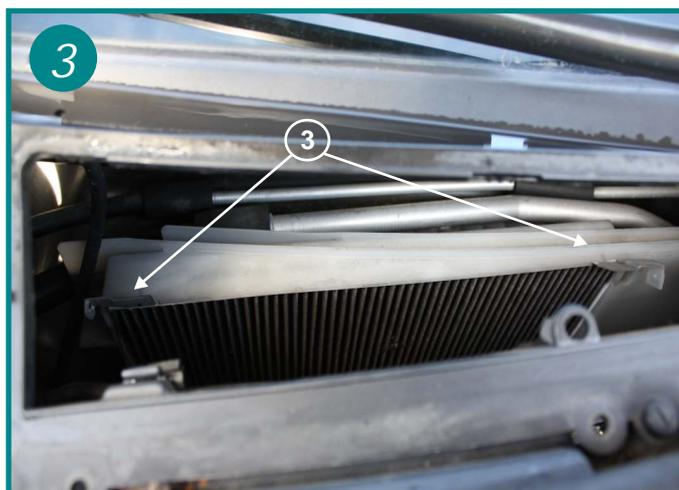
Soulever les 2 loquets de maintien du filtre en place (3) et dégager le filtre usagé.
