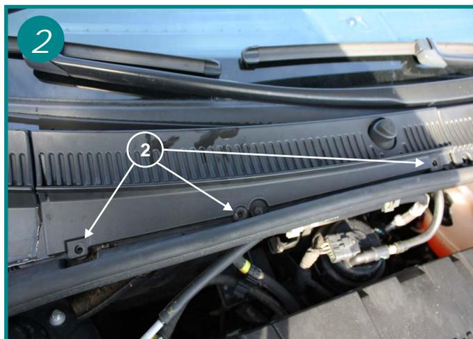
Retirer à l'aide d'un tournevis plat et en effectuant un quart de tour uniquement les 3 clips plastiques de fixation du couvercle de boîtier (2). Retirer celui-ci.
