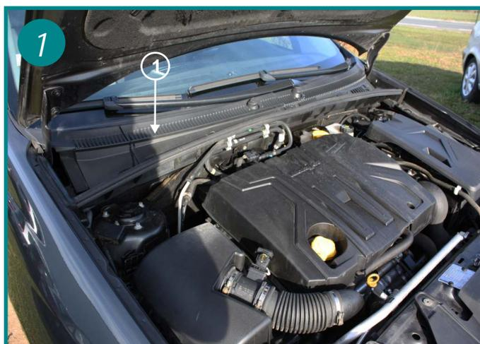
Le filtre d'habitacle est situé sous le capot moteur, côté passager devant la baie de pare-brise (1). Ouvrir le capot moteur.
