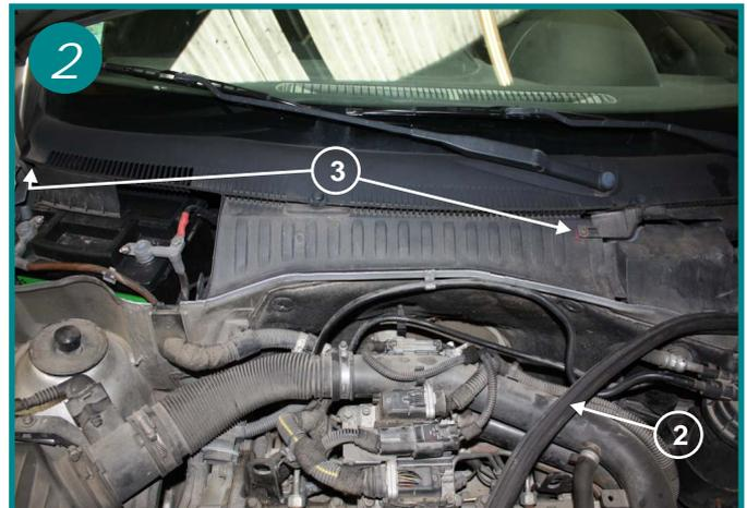
Retirer sur plus de la moitié le joint d'étanchéité (2)
