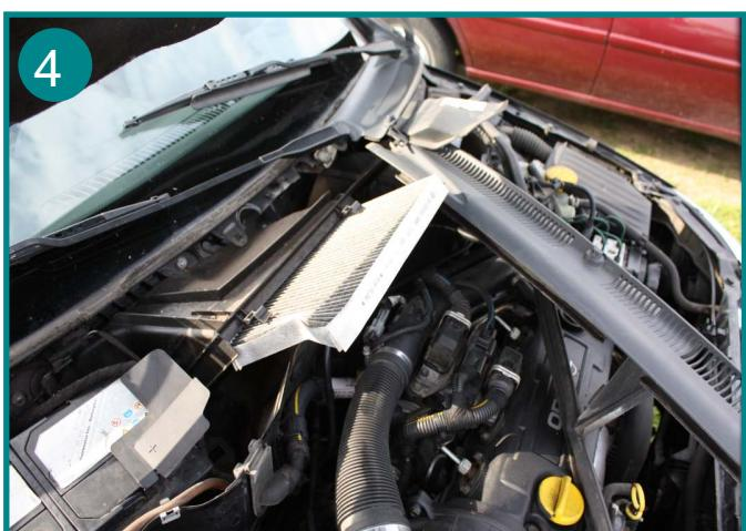
Sortir le filtre et le remplacer.
