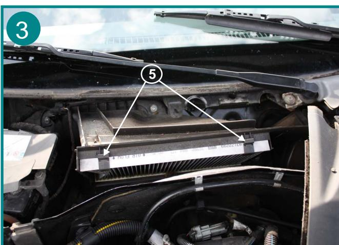
Soulever le 2 fermoirs (5) et extraire l 'élément filtrant usagé.
