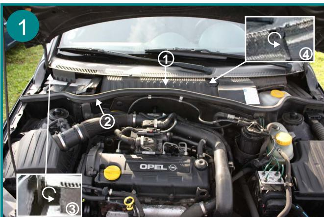
Le filtre d 'habitacle est situé sous le capot moteur, au centre devant la baie de pare-brise (1). Retirer sur une grande partie le joint d 'étanchéité (2). Dévisser la vis torx T20 (3) puis la vis Torx T20 (4).
