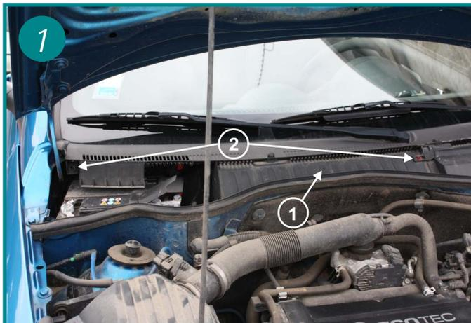
Le filtre d'habitacle est situé sous le capot moteur, au centre devant la baie de pare-brise (1). Dévisser les 2 vis Torx (T25) (2).
