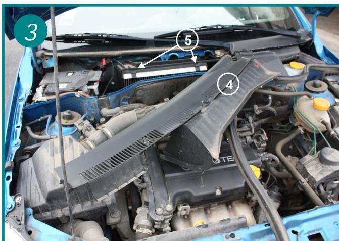
Déboîter et retirer partiellement le carter rigide (4) (ceci pour éviter d'endommager la durite de lave-glace). Basculer vers le haut les 2 fermetures (5) et extraire le filtre usagé.
