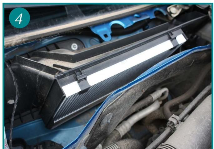
Replacer dans son logement un filtre neuf et basculer les 2 fermetures. Le remontage s'effectue dans l'ordre inverse du démontage.
