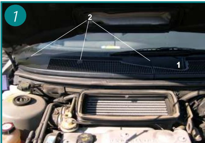
L'élément filtrant est situé dans le boîtier d'aération sous le capot moteur (du côté passager). Déboîter les cache-vis sur l'articulation du balai d'essuie glace droit et retirer celui-ci après avoir dévissé l'écrou hexagonal (1)
