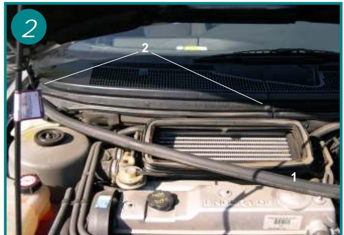
Oter le joint d'étanchéité entre le compartiment moteur et le conduit d'aération (1)
