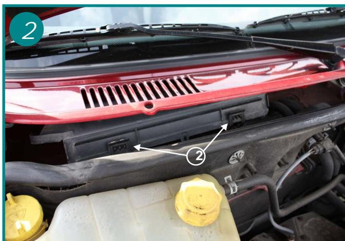
Exercez une pression vers le bas sur les 2 fermoirs du boîtier filtrant (2)
