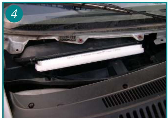
4 Replacer un nouvel élément dans son logement. Veiller à ce que le joint en mousse soit placé vers le bas. Le remontage s'effectue dans l'ordre inverse du démontage.
