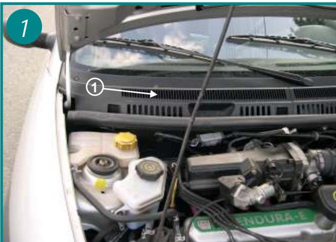
1 L'élément filtrant est situé sous la baie du pare brise sous le capot moteur coté passager (voir flèche 1). Ouvrir le capot moteur.
