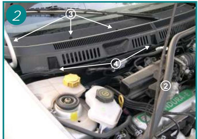
2 Retirer sur la moitié le joint d'étanchéité du compartiment moteur (2), puis les 3 caches et leur vis (flèche 3) et les 2 vis à tête cruciforme (flèche 4) pour retirer la moitié de la grille d'aération.
