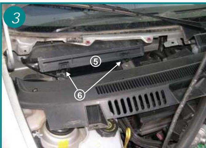
3 Localiser le boîtier du filtre (5). Actionner les 2 attaches plastiques (flèches 6). Soulever le volet pour en extraire l'élément filtrant usagé.
