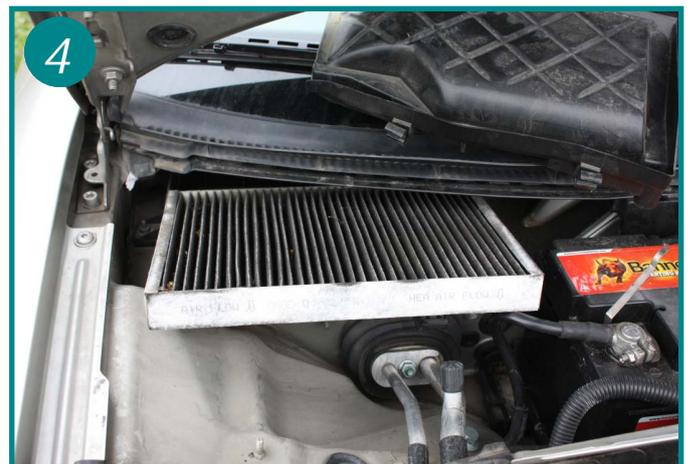
Remplacer le par un filtre neuf.
