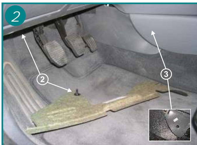
Retirer le cache situé sous le pédalier en déverrouillant la vis de maintien (voir flèche 2). Retirer également le cache qui est parallèle à la console centrale en dévissant la vis qui se trouve derrière ce cache (flèche 3 voir encadré)
