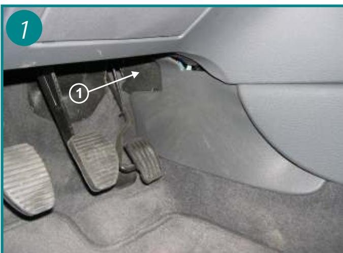
L'élément filtrant est situé dans l'habitacle du véhicule coté conducteur sous le poste de conduite (voir flèche 1).
