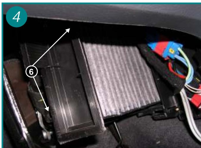
Dévisser les deux vis situées sur le couvercle tiroir de l'élément filtrant (flèche 6) pour extraire le filtre usagé. Le remontage s'effectue dans l'ordre inverse du démontage.
