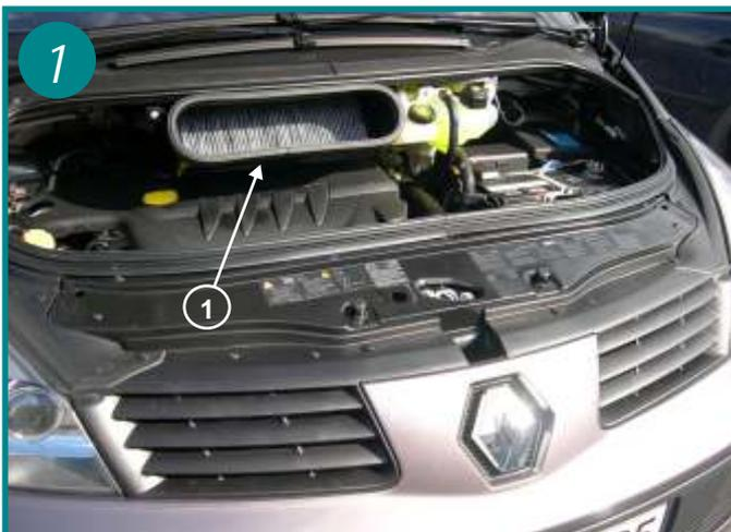
L'élément filtrant est situé sous le capot moteur au centre. Ouvrir le capot moteur (repère 1).
