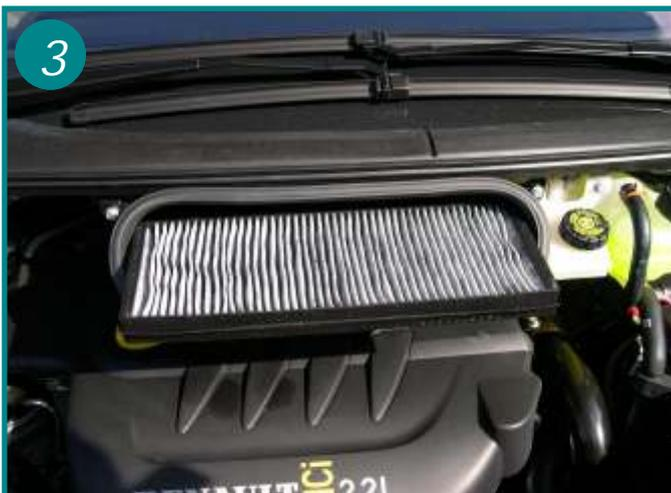
Sortir l'élément filtrant en le faisant pivoter vers l'avant.
