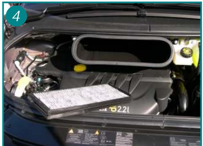
Remplacer l'élément filtrant. Aucun outil n'est nécessaire pour procéder à son remplacement. Le remplacer dans l'ordre inverse du démontage.
