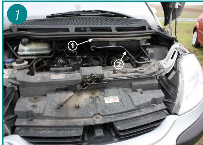
L'élément filtrant est situé sous le capot moteur côté conducteur (1)
