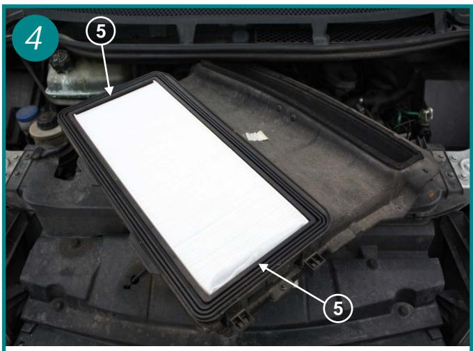
Remplacer l'élément filtrant en imbriquant les 2 premiers plis dans les nervures prévues (5).
