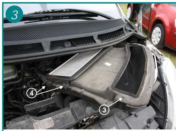
Dégager le boîtier tout d'abord par la gauche puis par la droite et le sortir totalement (voir détails des repères 3 et 4)
