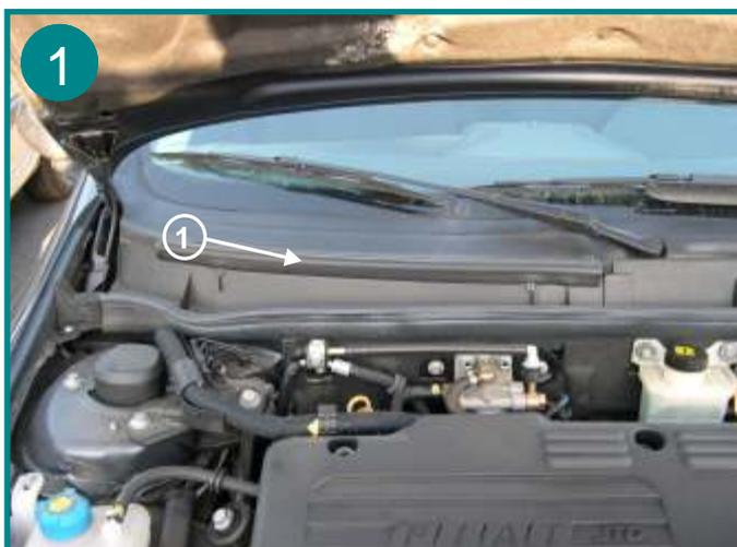
L'élément filtrant est situé sous la baie du pare brise du coté passager. Ouvrir le capot moteur et localiser le boîtier du filtre.
