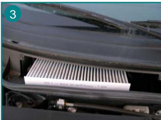
Replacer le nouvel élément filtrant en lieu et place du précédent . Veiller à bien repositionner les 2 clips plastiques
