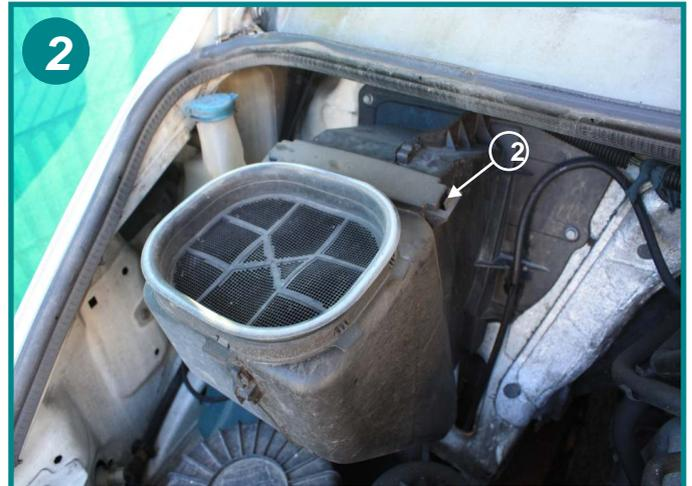
Ouvrir le boîtier filtrant en actionnant la patte de fermeture (2).
