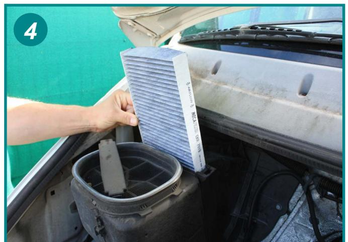
Glisser un élément filtrant neuf dans le boîtier et le refermer.
