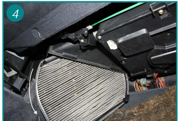
Extraire l'élément filtrant usagé vers le bas dans un mouvement légèrement circulaire.
