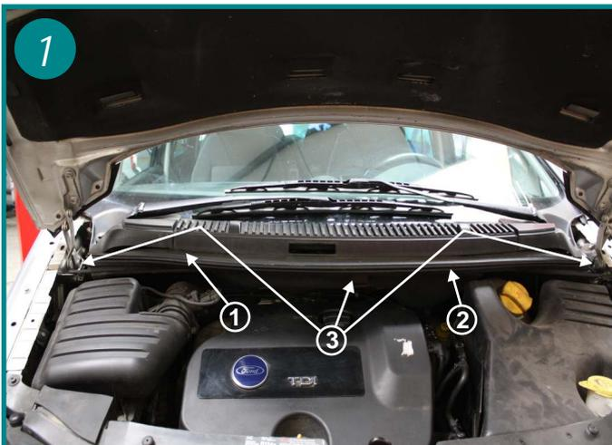
L'élément filtrant est situé sous le capot moteur sous la baie du pare brise derrière le mécanisme des essuie-glaces (1). Retirer le joint d'étanchéité (2) puis les 3 vis de 10 du plastron métallique (3).
