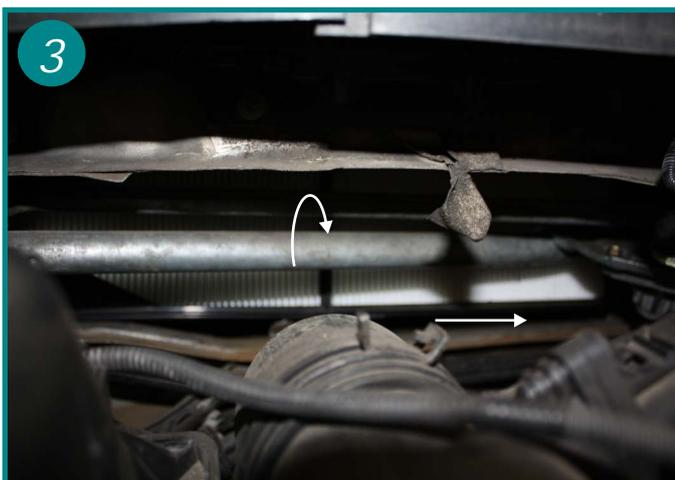
Le filtre est situé derrière le mécanisme d'essuie-glace, dans un cadre plastique amovible, faire glisser l'ensemble vers la droite et le sortir par le dessus (voir flèches).
