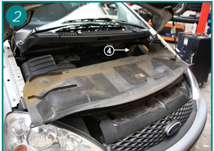
Sortir le plastron métallique en commençant par la gauche afin de le glisser ensuite vers la gauche ne pas être gêné par le bocal de refroidissement (4).
