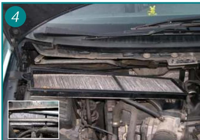
Retirer l'élément filtrant usagé de son cadre et le remplacer. Le remontage s'effectue dans l'ordre inverse du démontage.
