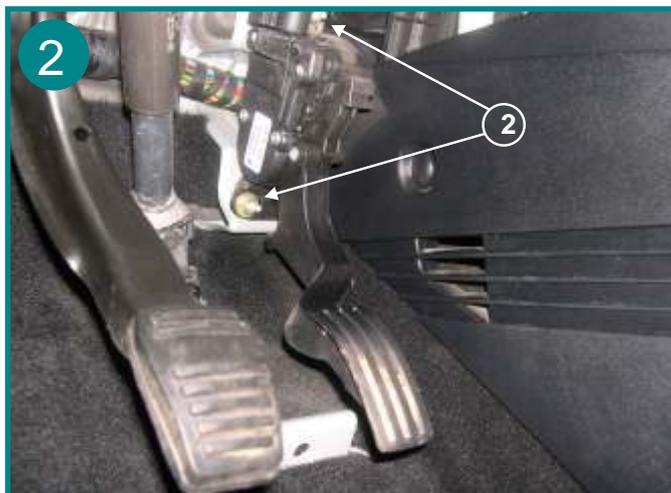
Dévisser les 3 écrous de fixation de la pédale d'accélérateur (voir flèche 2) et la déplacer sur le coté.
