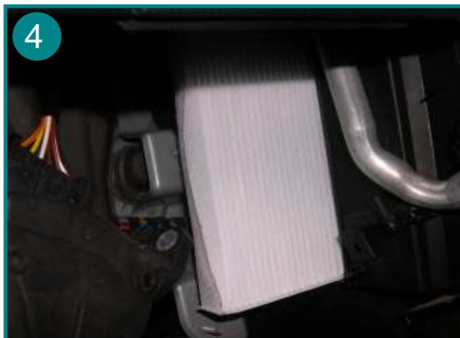
Retirer ensuite le couvercle du boîtier en dévissant ces 3 vis Torx de fixation. Sortir l'élément filtrant usagé en le faisant coulisser hors de son boîtier en le tordant légèrement. Le remontage s'effectue dans l'ordre inverse du démontage.
