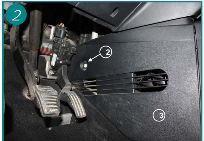
Retirer le clips plastique (2) et dégrafer la joue de la console centrale (3). Retirer ce carter dans sa totalité.
