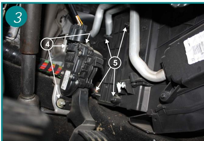
Dévisser les 3 écrous de 10 de fixation de la pédale d'accélérateur et la mettre de côté (4). Dévisser ensuite les 4 vis cruciformes (5) du couvercle du boîtier filtrant et retirer ce couvercle.
