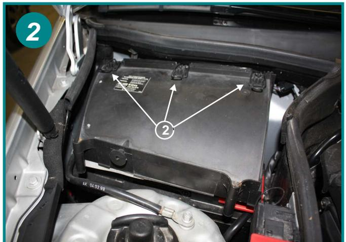
Déclipser les 3 fermetures (2), soulever le boîtier filtrant et le retourner.
