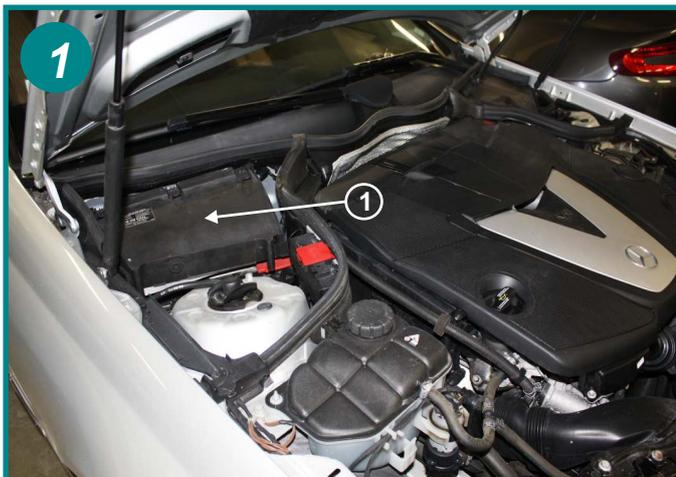
Le filtre d'habitation est situé sous le capot moteur, coté passager devant la baie de pare-brise (1). Ouvrir le capot moteur.
