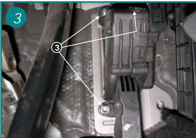
Dévisser les 3 boulons de 10 de maintien de la pédale d'accélérateur, et la mettre sur le côté (3).
