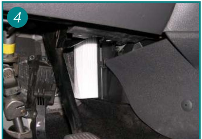
Ouvrir le boîtier filtrant en dévissant la vis de 5,5 mm sur le couvercle, extraire le filtre usagé et le remplacer. Le remontage s'effectue dans l'ordre inverse du démontage.
