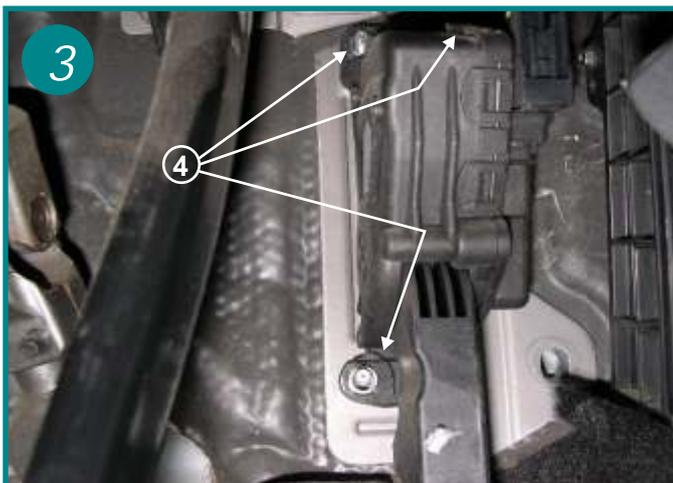
Dévisser les 3 écrous de 13 qui maintiennent la platine de la pédale d'accélérateur (4), retirer celle-ci sans la débrancher et la mettre sur le coté.
