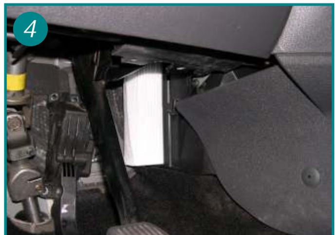
Ouvrir le boîtier filtrant et procéder au remplacement de l'élément filtrant. Le remontage s'effectue dans l'ordre inverse du démontage.
