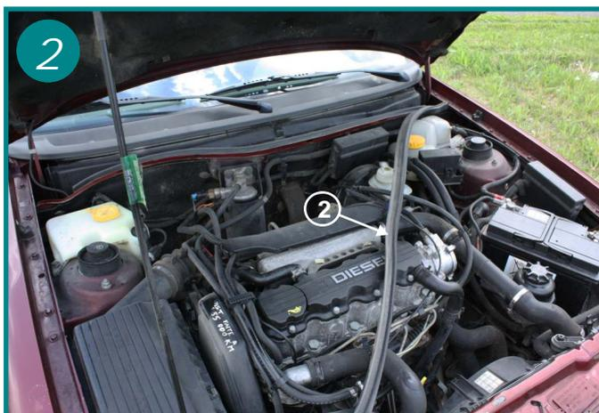
Retirer le joint d'étanchéité du compartiment moteur dans sa totalité (2).
