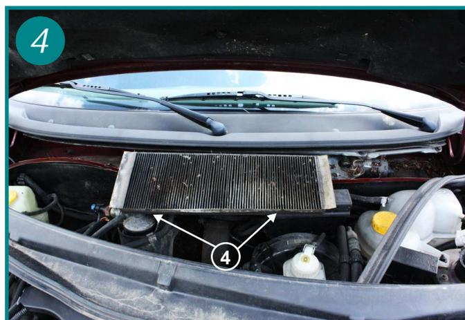
Basculer les 2 petits clips (4) et extraire le filtre usagé, une fois remplacé, le remontage s'effectue dans l'ordre inverse du démontage.
