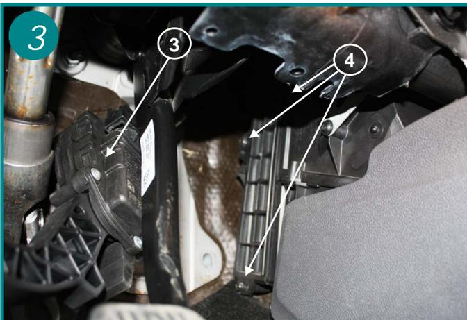
Mettre la pédale d'accélérateur sur le coté sans la débrancher (3), puis dévisser les 3 vis de 7 fixant le couvercle du boîtier filtrant (4). Le retirer.
