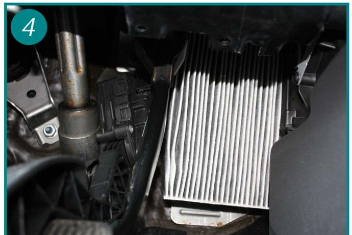
Extraire l'élément filtrant usagé en le déformant pour le sortir de son boîtier, la même action est à envisager pour remettre le filtre neuf. Le remontage s'effectue dans l'ordre inverse du démontage.
