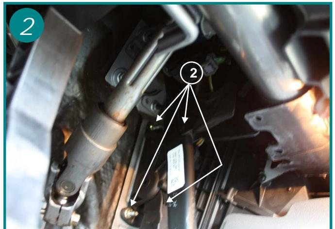
Dévisser la platine support de la pédale d'accélérateur elle est fixée par 3 vis de 10 et une vis de 13 (2).
