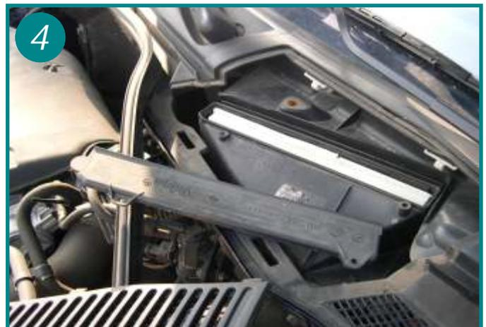
Placer le nouvel élément filtrant dans le boîtier. Veiller à ce que l'inscription rouge sur l'élément filtrant soit tournée vers le bas (voir flèche). Remonter le couvercle plastique et l'encliquer. Le remontage s'effectue dans l'ordre inverse du démontage.
