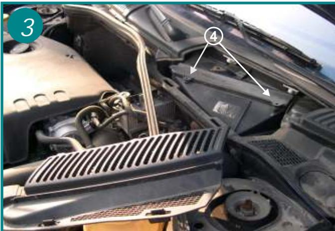
Défaire les vis Torx sur le boîtier du filtre (flèche 4). Pour cela il faut utiliser un tournevis avec empreinte n°20. Soulever le couvercle en plastique sur le côté gauche (languette) et l'enlever. Retirer l'élément filtrant usagé.
