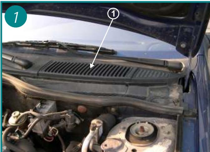
L'élément filtrant est situé sur le côté gauche (coté conducteur) sous le capot moteur (voir flèche 1). Ouvrir le capot moteur.
