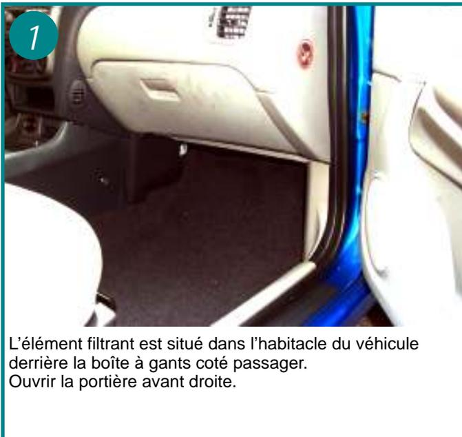
L'élément filtrant est situé dans l'habitacle du véhicule derrière la boîte à gants coté passager. Ouvrir la portière avant droite.
