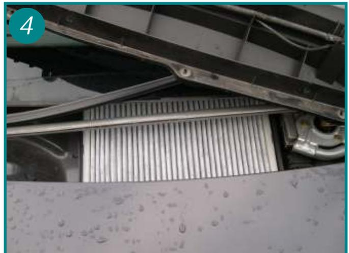
Remplacer le filtre d'habitacle en le positionnant la flèche vers le bas (flèche imprimée sur l'élément). Le remontage s'effectue dans l'ordre inverse du démontage.
