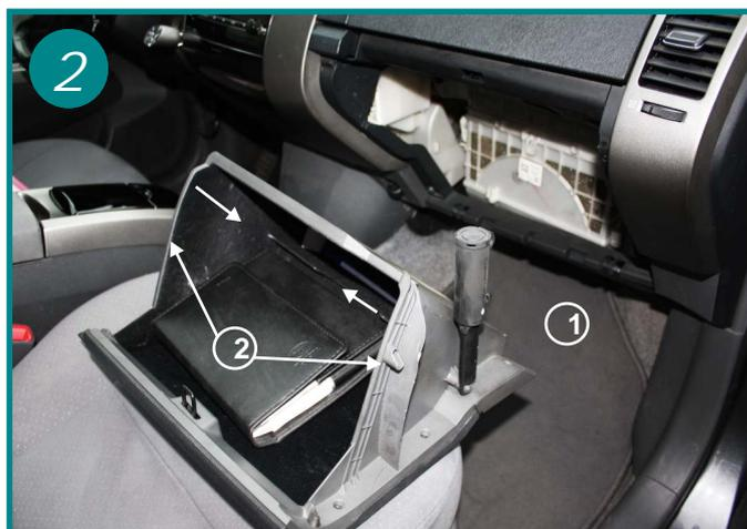
Démonter la boîte à gants, pour cela appuyer sur les flancs du tiroir (2) afin de dégager les ergots de retenue et désaccoupler l'amortisseur (3) puis l'extraire en tirant dessus.
