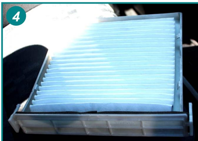
Remplacer l'élément filtrant usagé en le retirant de son cadre.
