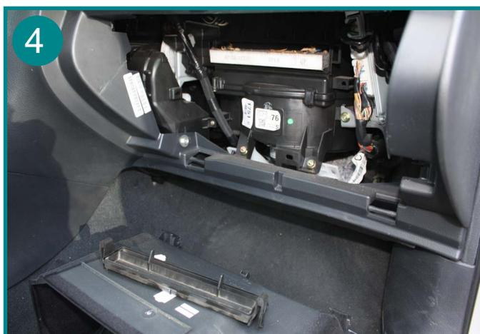
Extraire l'élément filtrant usagé et le remplacer.
