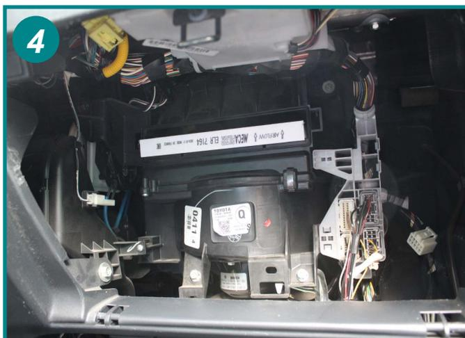
Extraire l'élément filtrant usagé et procéder à son remplacement. Le remontage s'effectue dans l'ordre inverse du démontage.
