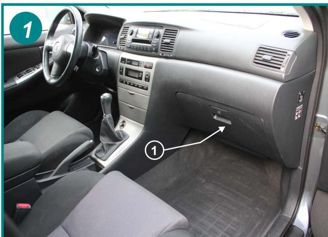
Le filtre d'habitacle est situé à l'intérieur du véhicule, côté passager derrière la boîte à gants (1). Ouvrir la boîte à gants.
