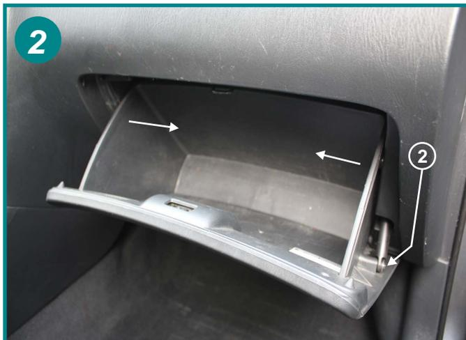
Dévisser la vis cruciforme (2) et libérer l'amortisseur d'ouverture de boîte. Presser sur les flancs de celle-ci vers l'intérieur pour dégager les arrêtoirs. Sortir le tiroir de ses gonds et le mettre sur le côté.
