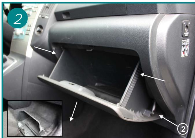
Dévisser la vis cruciforme (2) pour dé-accoupler l'amortisseur de retenue de la boîte à gants. Presser sur ces flancs (voir flèches) et retirer dans sa totalité le tiroir de boîte (voir encadré)
