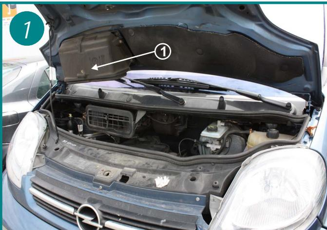
Le filtre d'habitacle est situé sous et sur le capot moteur à l'intérieur de la bouche de ventilation (1).
