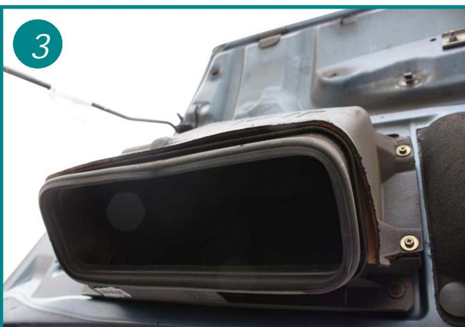
Nettoyer la bouche d'aération avant de placer le nouvel élément dans la glissière prévue à l'intérieur. Remarque: 2 ergots sont placés derrière le filtre pour un montage plus aisé.
