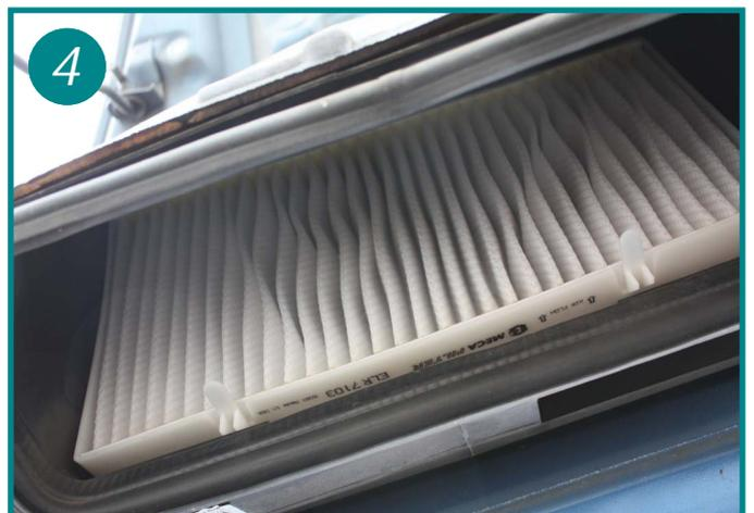
Replacer le nouvel élément dans son boîtier. Aucun outil n'est nécessaire à ce remplacement de filtre.
