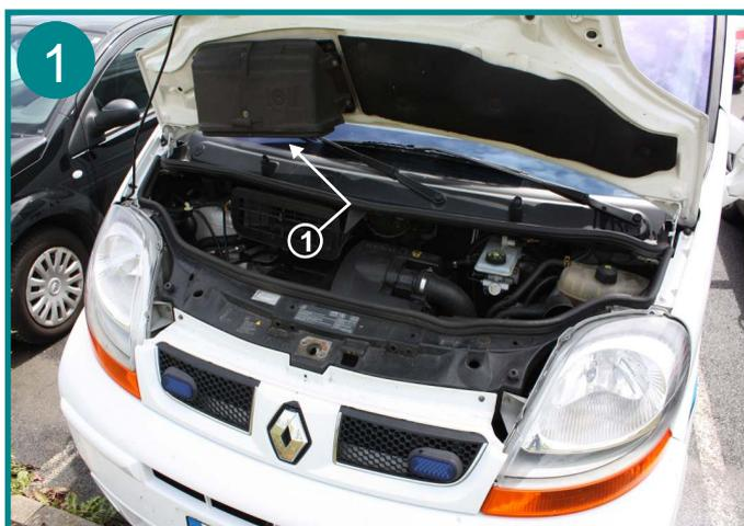
Le filtre d'habitacle est situé sous et sur le capot moteur, côté passager (1).
