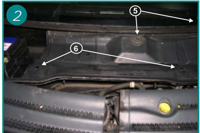
Retirer les 2 écrous hexagonaux plastiques et rondelles d'appui des axes de bras d'essuie-glaces (voir flèche 5) Enlever les 2 agrafes de fixation sur le couvercle plastique (voir flèche 6) Retirer le couvercle plastique.
