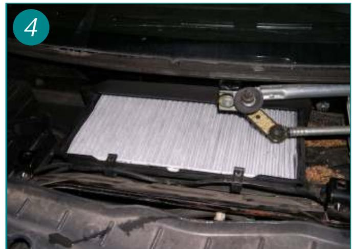
Installer le nouvel élément en veillant à positionner le joint mousse vers le bas. Faire glisser l'élément jusqu'au fond de son logement en compressant légèrement le joint et le faire basculer pour l'encliqueter correctement. Le remontage s'effectue dans l'ordre inverse du démontage.
