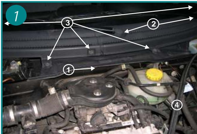
L'élément filtrant est situé sous le capot moteur au centre. (Flèche 1). Retirer les essuies-glace après avoir dévissé les écrous hexagonaux(2). Desserrer les 5 vis de la grille d'aération et la retirer (flèche 3) Oter le joint d'étanchéité du compartiment moteur (flèche 4).
