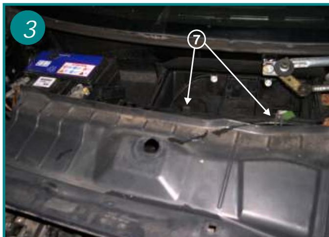
Basculer les 2 clips plastiques sur le boîtier du filtre (flèche 7). Dégager l'élément filtrant usagé.
