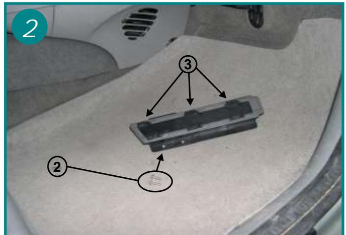
Dévisser les 2 vis de fixation du couvercle du boîtier filtrant (voir flèche 2) faire coulisser le couvercle de 20 mm vers la gauche afin de désolidariser les ergots (flèche 3). Retirer ce couvercle.
