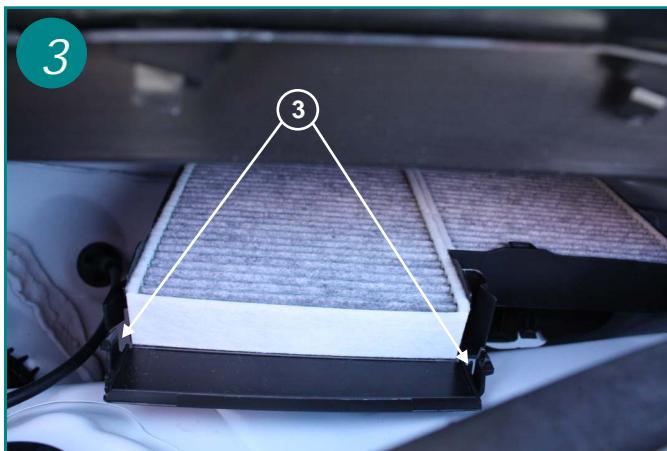
Basculer la trappe d 'ouverture du boîtier en agissant sur les 2 loquets aux deux extrémités du couvercle (3).
