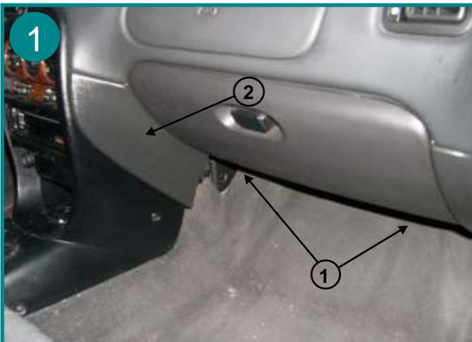
L'élément filtrant est situé derrière la boîte à gants dans l'habitacle du véhicule.
