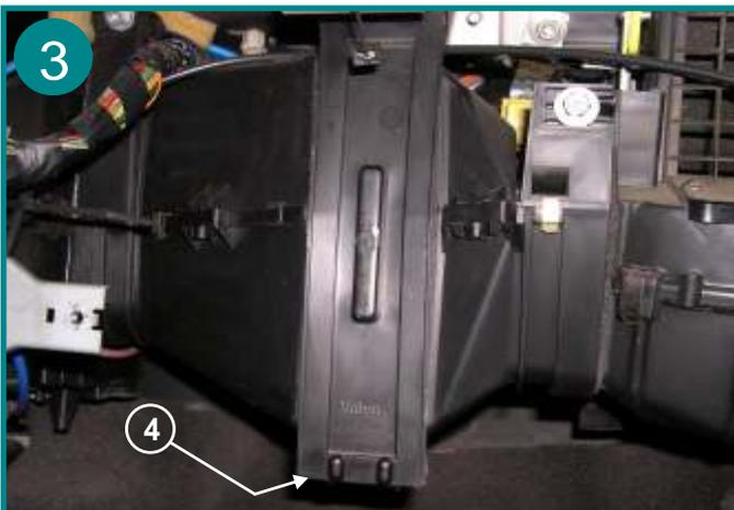
Déclipser le couvercle du boîtier de l'élément filtrant par le bas (voir flèche 4) et le retirer.
