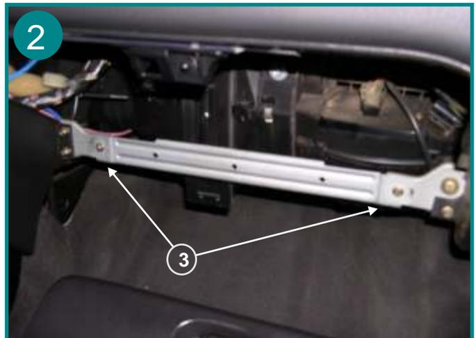
Dévisser également la traverse métallique qui sert de renfort à la boîte à gants, elle est fixée par 2 vis (voir flèche 3) et la retirer
