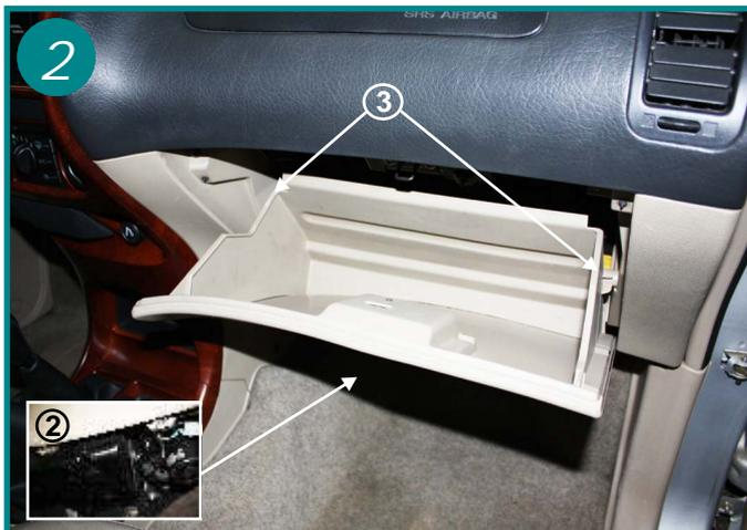
Ouvrir la boîte à gants et dévisser par dessous les 2 vis cruciformes de fixation (2) (voir encadré). Puis retirer celle-ci en dégageant les 2 butées d'arrêt (3)
