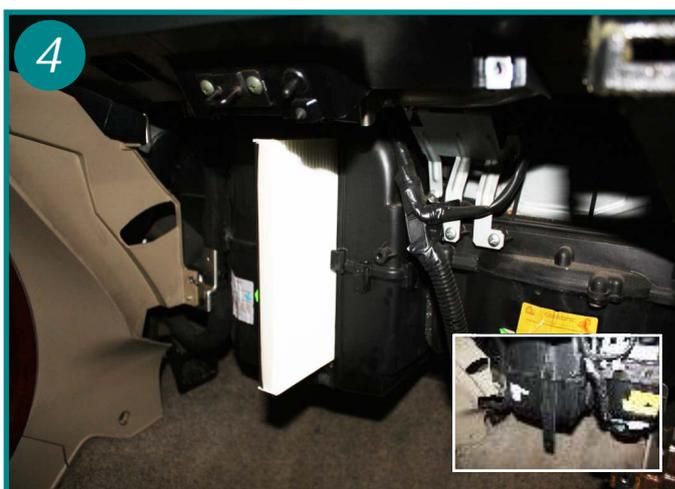
Ouvrir le boîtier filtrant en dévissant la vis cruciforme, puis faire coulisser le couvercle par le bas (voir encadré). Extraire le filtre usagé et le remplacer. Le remontage s'effectue dans l'ordre inverse du démontage.
