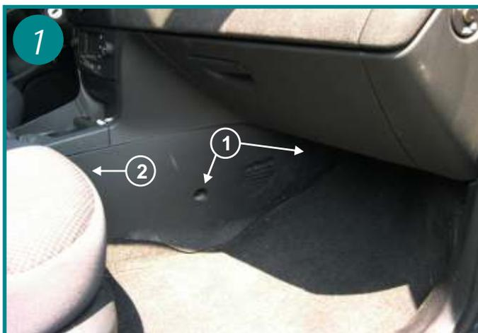
L'élément filtrant habitacle se trouve du coté passager à l'intérieur du véhicule derrière la console centrale, pour le démonter procéder comme suit: retirer la paroi plastique de la console en retirant les 2 clips plastiques (1) et l'agrafe de maintien (2) ATTENTION LES 2 CLIPS SONT FRAGILES ET CASSENT FACILEMENT.
