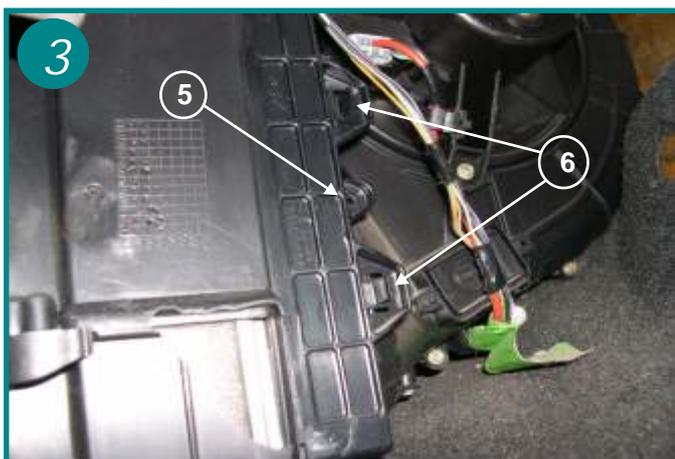
Une fois le cache retiré, vous avez accès directement au climatiseur. Dévisser à l'aide d'une clé hexagonale de 8mm la vis de maintien du couvercle(5) et désolidariser celui-ci en appuyant sur les 2 ergots de fermeture (6).
